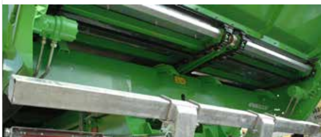
Napęd przenośnika dwoma silnikami hydraulicznymi
