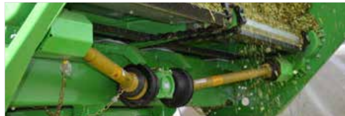
Napęd mechaniczny wałkiem Kardana
