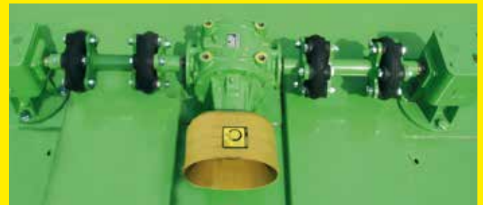
Wałek przekładnika z poczwórnym zabezpieczeniem przeciw skręcaniu
