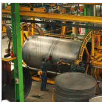
Łączenie segmentów i dennic zbiorników
