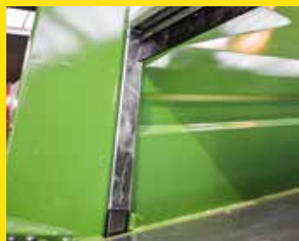
Drzwi suwane przeciw zapychaniu
