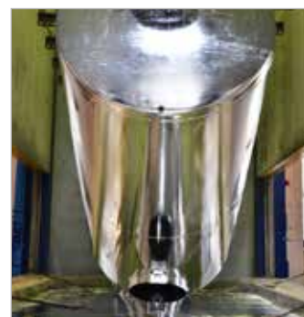
Cynkowanie ogniowe (dwustronne)
