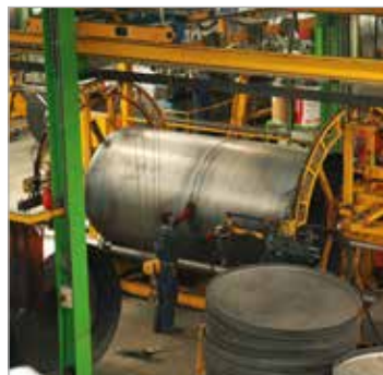
Łączenie segmentów i dennic zbiorników
