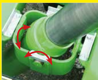
Przegub o podwójnej osi obrotu, w którym osadzony jest siłownik
