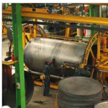
Łączenie segmentów i dennic zbiorników
