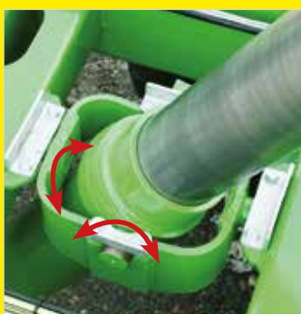
Przegub o podwójnej osi obrotu, w którym osadzony jest siłownik
