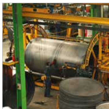
Łączenie segmentów i dennic zbiorników
